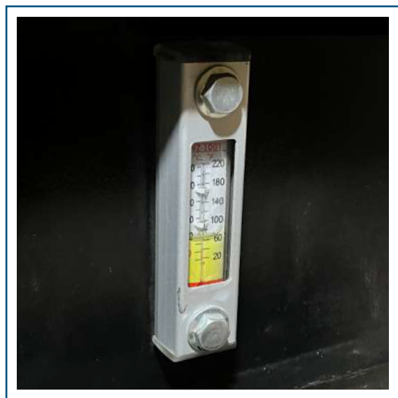
Medidor de combustible
