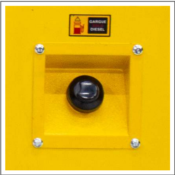
Carga de combustible
