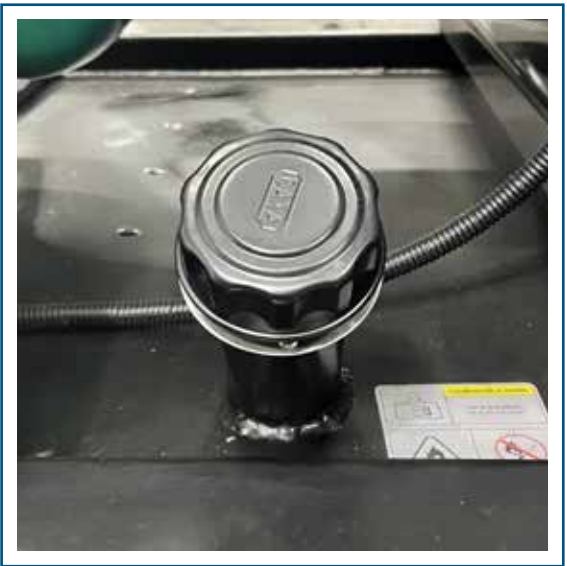
Carga de combustible
